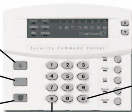
Premendo [#] si esce da una sezione senza modificare i dati nell'opzione attuale.
